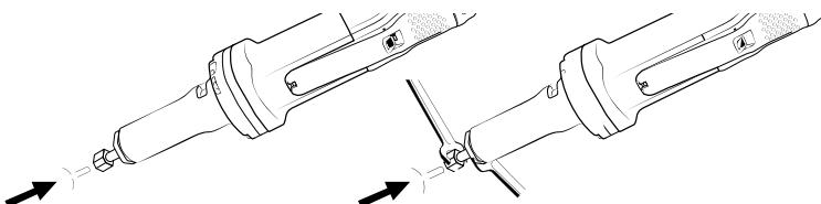
اجازه دهید که دستگاه حداقل یک دقیقه بدون بار کار کند تا از مونتاژ درست آن اطمینان حاصل نمایید. اگر سنگ انگشتی لنگ می‌زد و یا لرزش داشت فوراً آن را تعویض نمایید.
