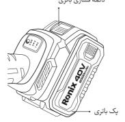
برای جدا کردن پک باتری، در حالی که دکمه فشاری جلوی باتری را میکشید، آن را از روی ابزار بلغزانید. برای نصب پک باتری، زبانه روی باتری را با شیار موجود در محفظه تراز کرده و آن را در جای خود قبل شود. اگر می توانید جای خود قبل شود. اگر می توانید نشانگر قرمز رنگ را در سمت بالای دکمه ببینید، کاملاً قبل نشده است.
