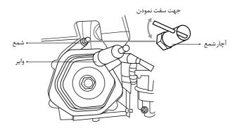
۳- شمع را از لحاظ خرابی الکترود و شکستگی بدنه سرامیکی بررسی نمایید و در صورت وجود مشكل آنرا تعويض نماييد.
